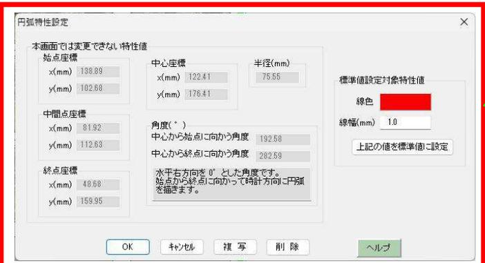
又、円弧上にマウスを移動した後、右クリックするとこの<円弧特性設定>画面が表示されますので、この画面で円弧の特性を変更できます。
